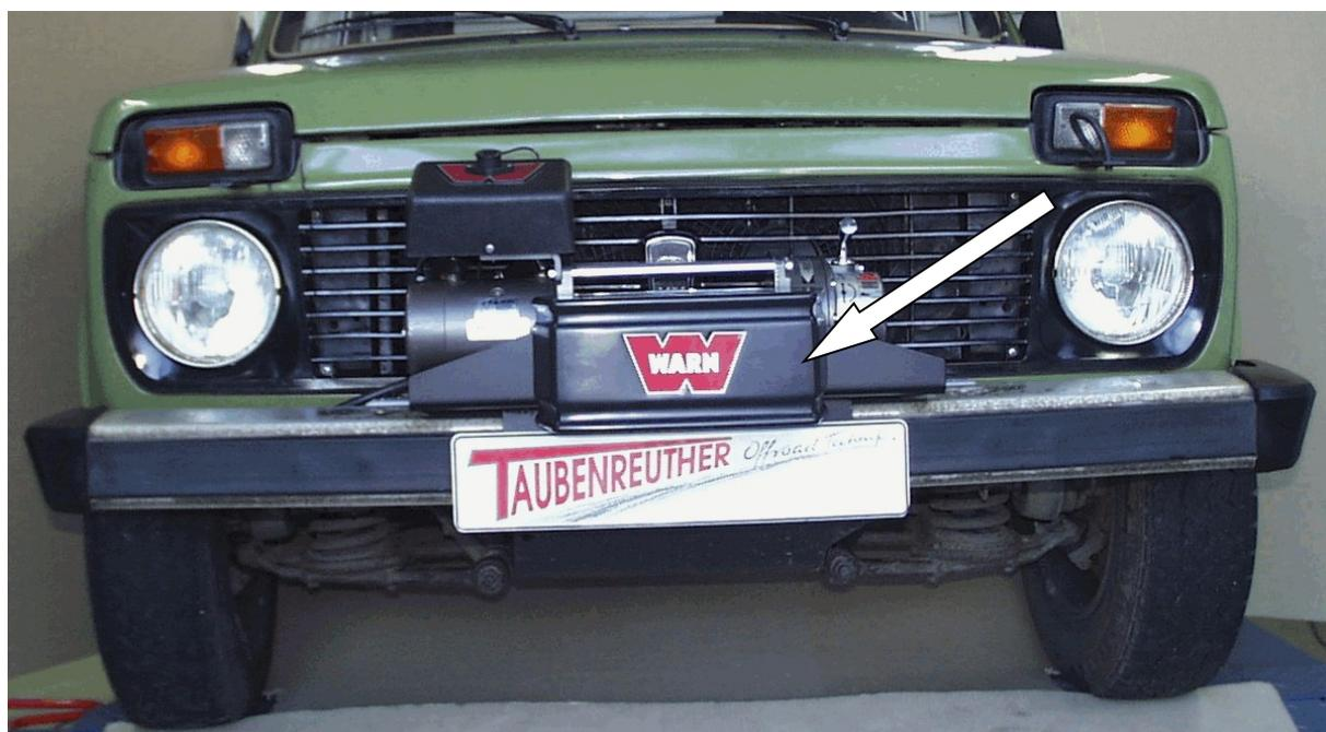
Hier sehen sie den fertig montierten Seilwindenanbausatz.
